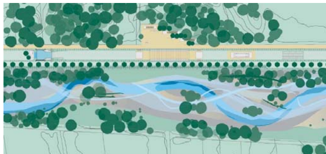
Fig. 2 Création d'un nouveau lit en tresse et transformation de l'ancien canal en promenade (dessin ADR).
