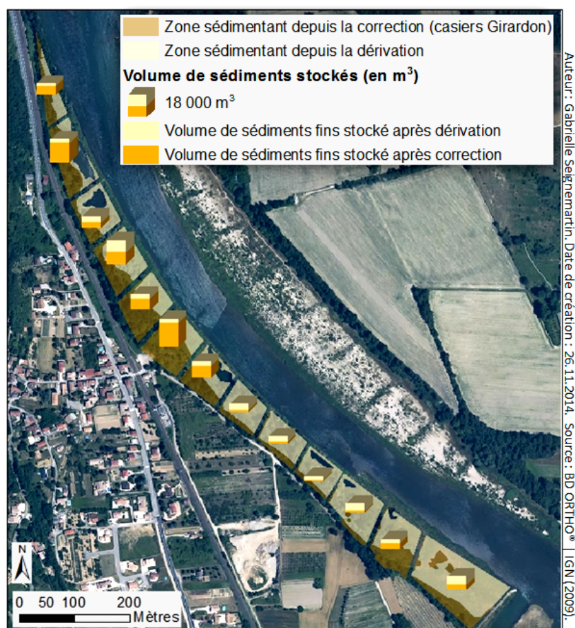
Figure 2 : Carte des volumes de sédiments fins stockés estimés pour chacune des phases d'aménagement sur le tronçon amont (PK52.7 à 53.7) du secteur de Péage-de-Roussillon
