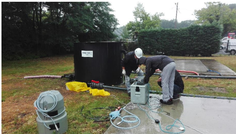
Photo 4 : Prélèvements en aval de la conduite de refoulement.
