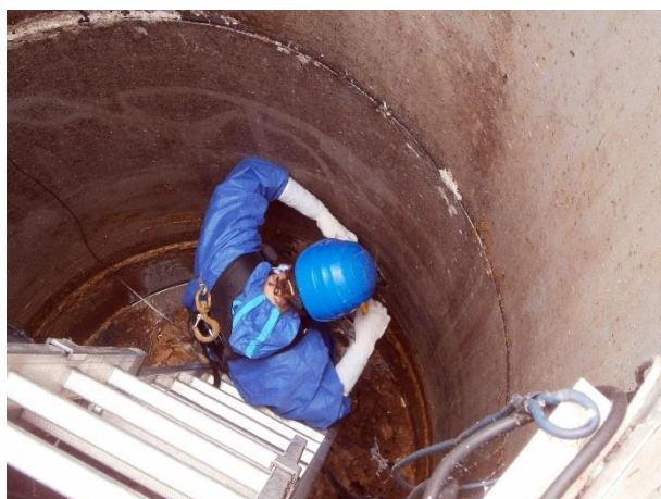
Photo 8 : Prélèvement de biofilm amont dans la bache de la station de pompage.
