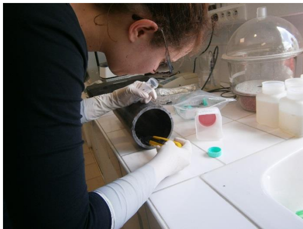
Photo 10 : Prélèvement d'un échantillon de biofilm aval sur le morceau de conduite excavé de la tranchée.
