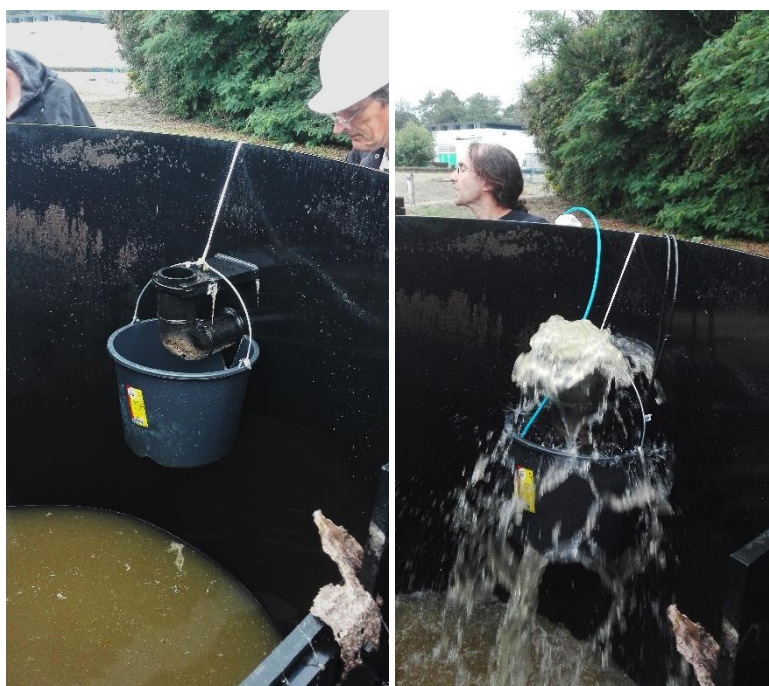
Photo 3 : Seau avec surverse installé pour permettre le prélèvement des eaux usées à l'exutoire de la conduite de refoulement.
