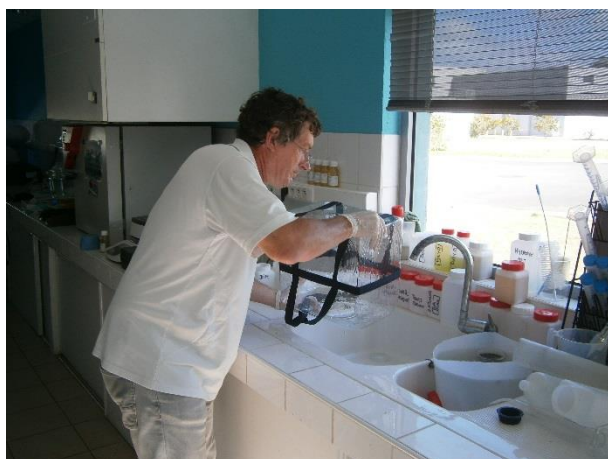
Photo 5 : Rinçage et lavage des flacons verre de 16 L de collecte des échantillons amont et aval.
