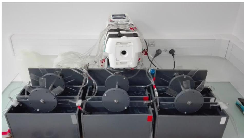
Figure 7 : Dispositif pilote de développement de biofilm.
