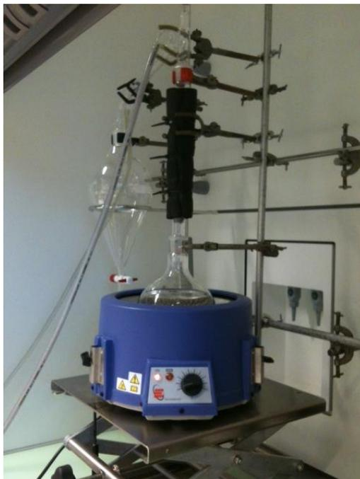
**Figure 33:** Montage de distillation réel et utilisé dans la cadre de ces travaux
