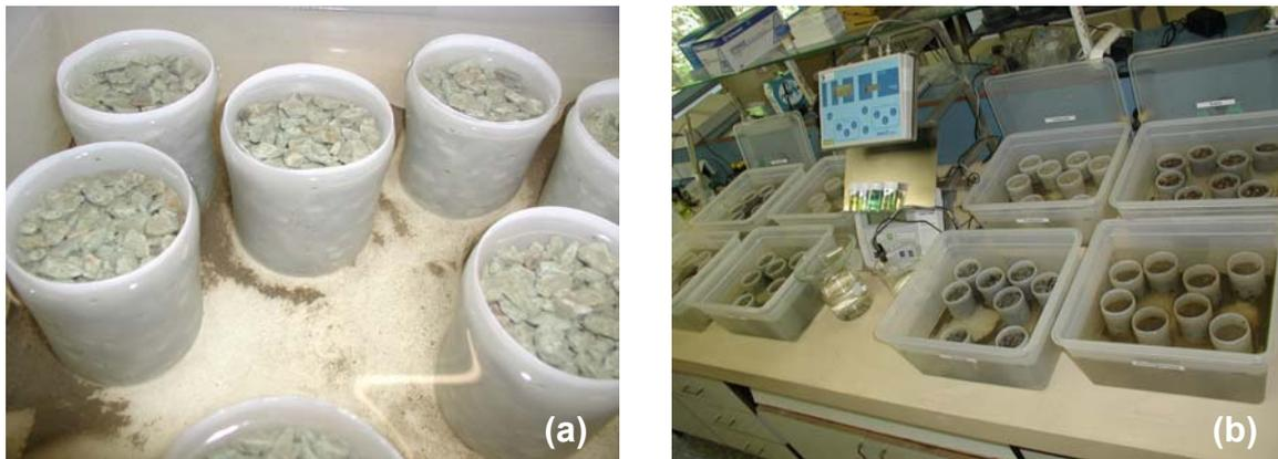
**Illustration 6 : (a) Pots percés contenant le matériau étudié submergé par l'eau collectée en entrée du bassin d'infiltration. (b) Système expérimental de sélection des matériaux susceptibles de défavoriser la colonisation par les bactéries, des eaux pluviales collectées en entrée du bassin d'infiltration du site de Django Reinhardt.**
