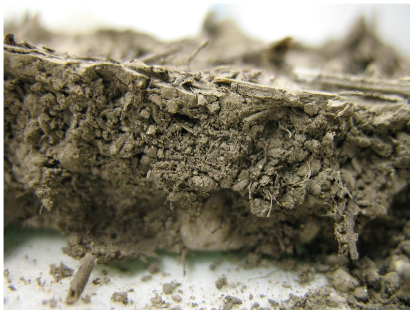
Figure 5 : Photo de la couche de sédiment séchée à la fin de l'expérience de séchage artificiel au laboratoire
