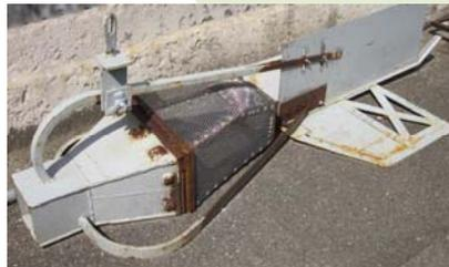
Préleveur de suspension sableuse : bouteille de Delft
