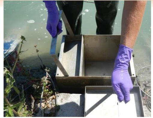
9- Repositionner le couvercle sur le piège. La lamelle peut empêcher le couvercle de s'emboîter correctement ; dans ce cas, ressortir le grand bac et l'insérer dans le sens inverse.
