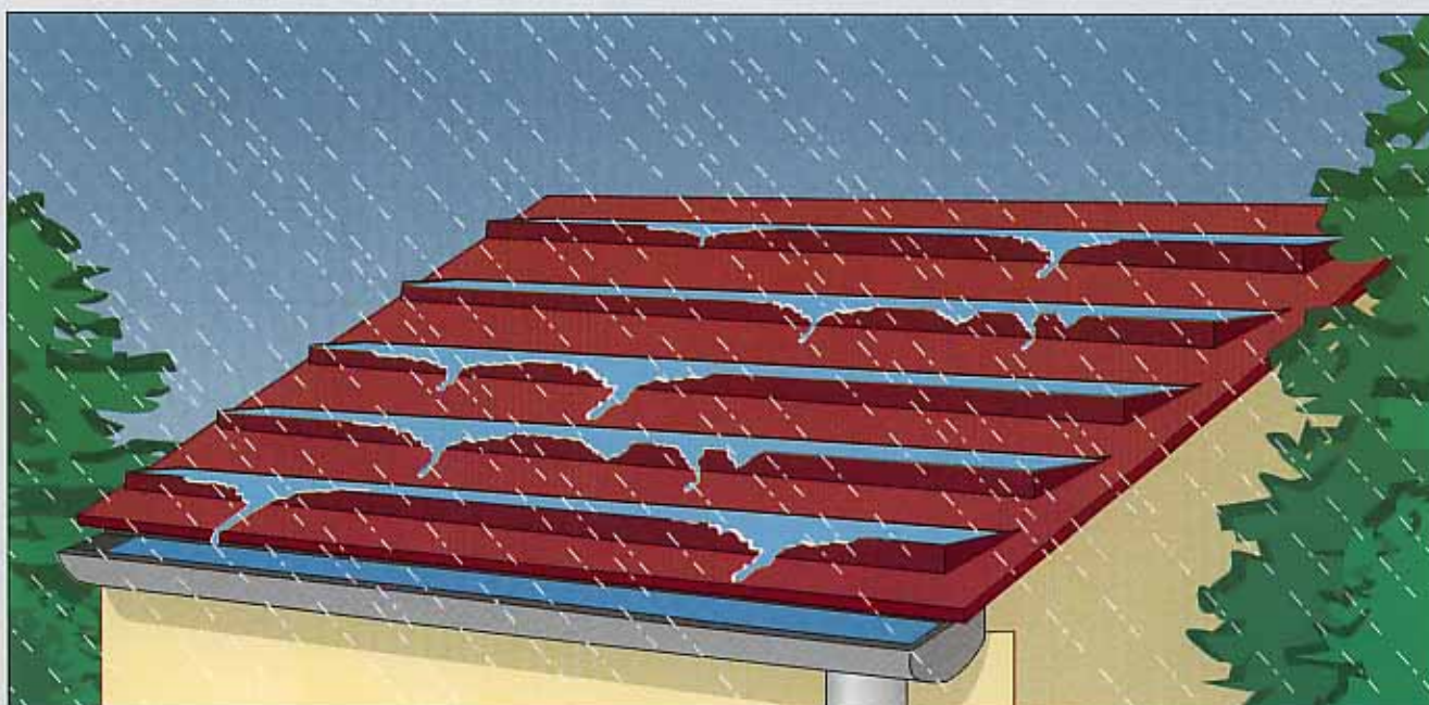
Schéma de stockage sur toit en pente
