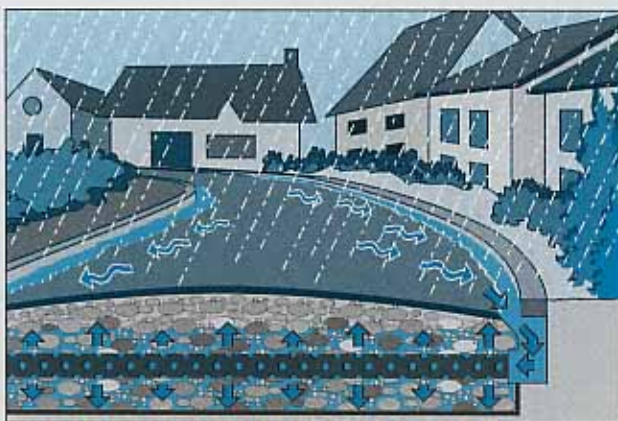
Revêtement imperméable : injection par un drain
