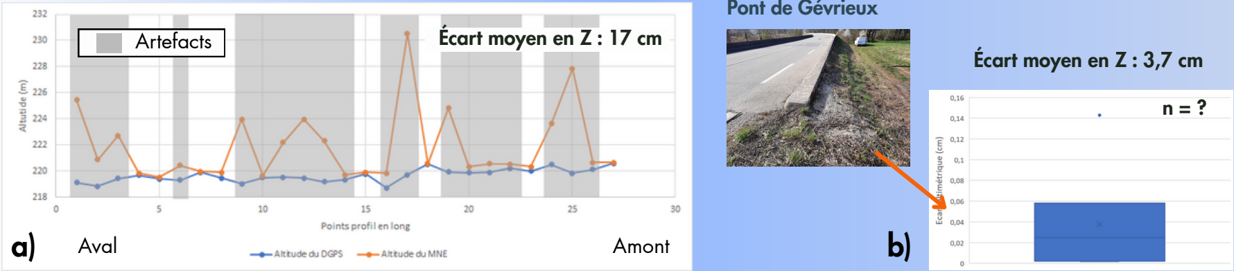
Figure 22. a) Comparaison entre profil en long altimétrie SfM et altimétrie DGNSS, b) Écart entre altimétrie SfM et point de contrôle in-situ DGNSS, site 1 - mission du 25/03/2022
