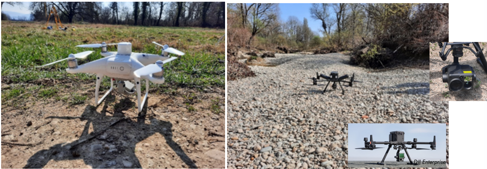
Figure 3. a) Phantom 4 RTK (DJI), b) Matrice 300 RTK (DJI) avec capteur LiDAR Zenmuse L1 et caméra thermique H20T (DJI)
