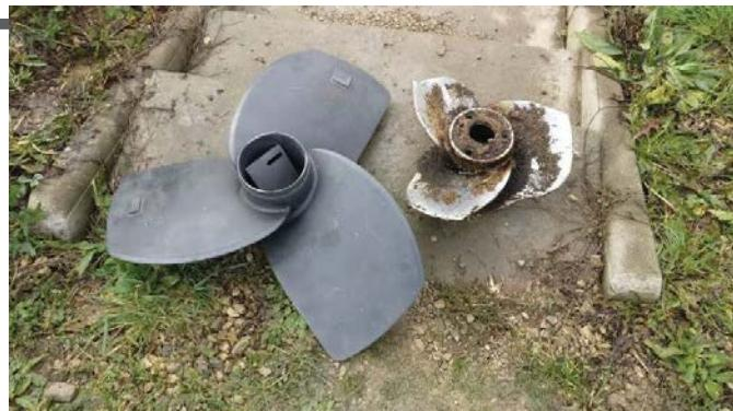
Hélice d'agitation (neuve et après 3 ans!) du digesteur de la ferme expérimentale de La Bouzule (54)
