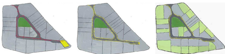
Voiries (CR* 0.95) Toitures, Parkings et autres surfaces (CR* 0.70) Espaces verts (CR* 0.25) Réseau Pluvial Toitures végétalisées Bassin d'infiltration Noues d'infiltration Schémas de principe des 3 scénarios de gestion des Eaux pluviales (*CR : Coefficient de ruissellement)
