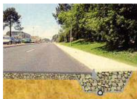
Stockage sous trottoir
