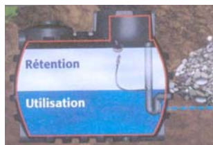
Cuve de récupération et rétention avec débit régulé
