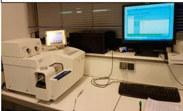
Spectroscopie infrarouge à transformée de Fourier
