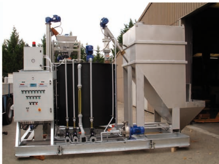
Skid de préparation de BENTONITE
