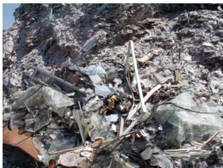
**Le verre de construction, déchet inerte, est souvent associé à des produits non inertes.**
