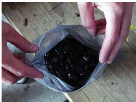
**Bois contaminé transformé en charbon de bois propre après thermolyse.**
