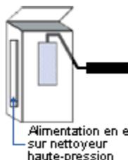
Il fonctionne de la même façon que l'appareil précédent excepté qu'il possède un cycle de lavage plus rapide et plus puissant puisque son raccordement d'eau s'effectue sur un nettoyeur haute-pression. Trois gicleurs assurent un nettoyage en profondeur. Grâce à la rotation rapide, le rouleau s'essore auto-matiquement dès la coupure d'arrivée d'eau.
