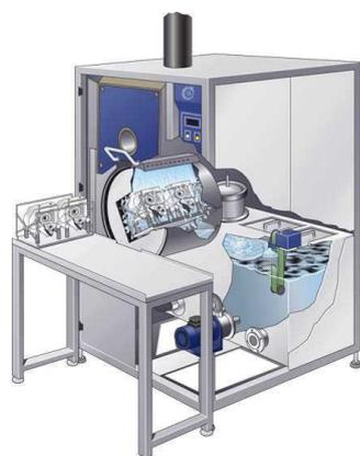
*Avantage :* Peu de consommation et de rejet d'eau. La production de déchet dangereux est moindre que dans le cas des fontaines à solvants. Moins de produit dangereux utilisé. Possibilité d'investir dans des machines capables de nettoyer des grosses pièces comme un moteur complet (dessin de gauche)
