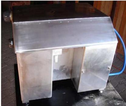
Une fois par jour, une résistance électrique liquéfie les graisses. Ensuite, un obturateur ferme la sortie des effluents et de l'eau est injectée en bas du réservoir. La graisse en surface est chassée par un dispositif de surverse, vers un réservoir extérieur.
