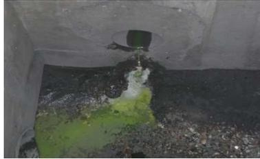
Comme le montre l'analyse en EP6, il existe une connexion en amont entre eaux usées et eaux pluviales. On retrouve donc la fluorescéine en EP3.
