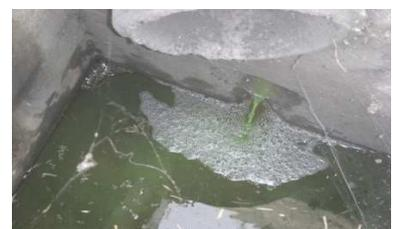
Arrivée d'un débit faible de fluorescéine en EP6 montrant une connexion entre les eaux usées sanitaires et les eaux pluviales.
