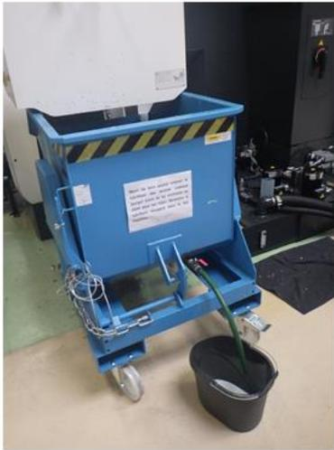
Benne de collecte des copeaux au cul de la machine équipée d'un robinet permettant la récupération de l'huile
