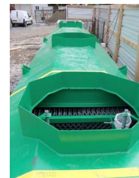
Décanteur lamellaire (Source : Chambéry Métropole)
