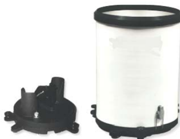
Illust. 2: Pluviographe à augets basculants (Hydreka PL2)
