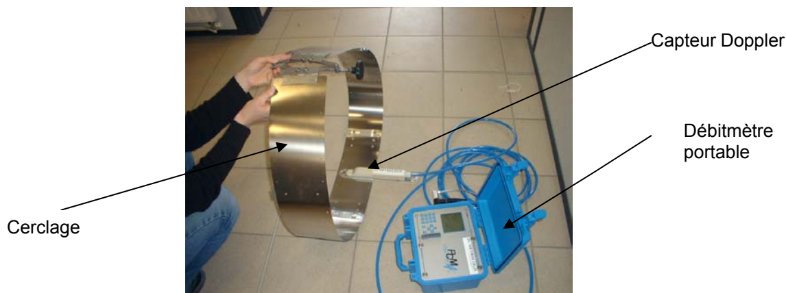
Illust. 1: Exemple de cerclage métallique préfabriqué pour fixation d'un capteur Doppler dans les collecteurs circulaires (Crédit photo Chambéry Métropole)
