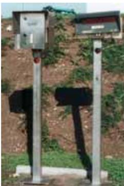
Photo 6 : Borne à carte électromagnétique reliée à un système d'information pour la pesée par pont bascule, Arras
