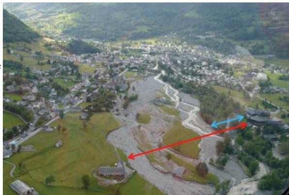
La flèche bleue montre la largeur du corridor boisé au sein duquel coulait le Bastan avant la crue, la flèche en rouge illustre la largeur du lit après la crue
