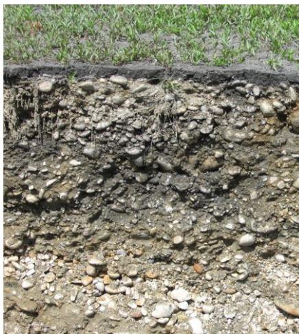
*Exemple de coupe de sol en fond du bassin d'infiltration de Django Reinhardt (Chassieu).*
