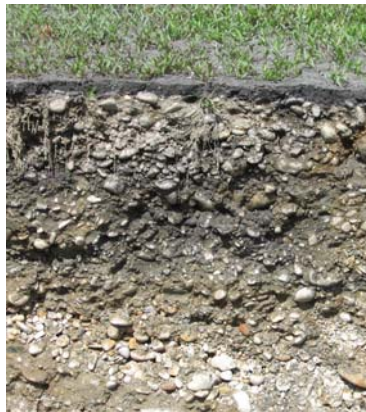
Figure 3 : Exemple de coupe de sol en fond du bassin d'infiltration de Django Reinhardt (Chassieu). On voit nettement une couche noire de surface dont la granulométrie est fine. Cette couche se retrouve sur tous les bassins du même type.
