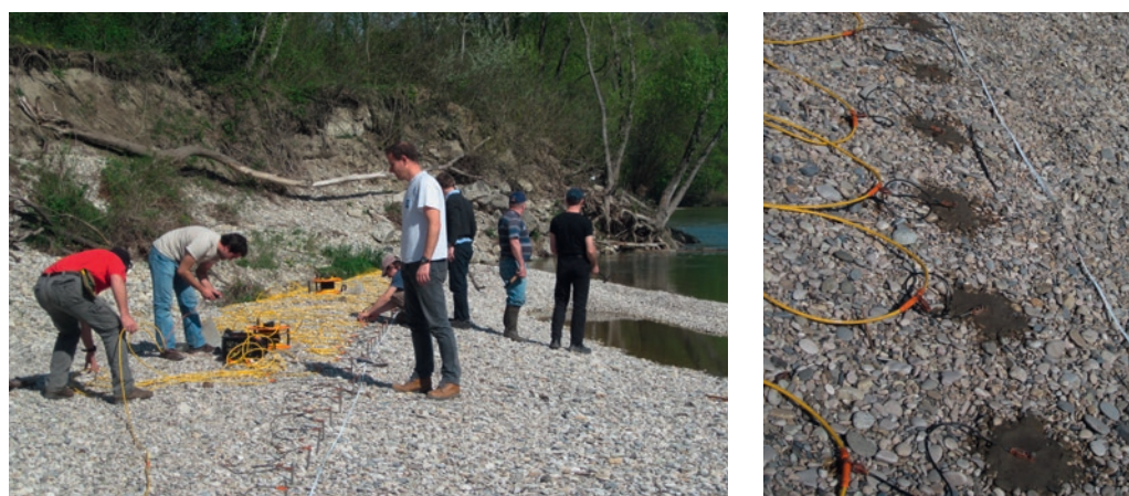
Figure 11 À gauche, campagne d'acquisition en tomographie de résistivité électrique. À droite, matériel d'acquisition et injection d'un courant électrique entre différentes électrodes.
