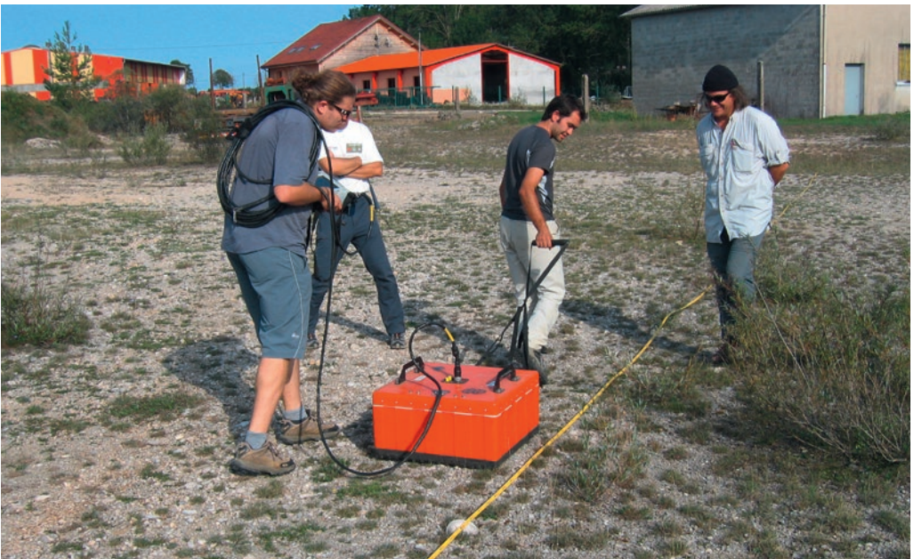
Figure 9 Campagne d'acquisition au radar géologique (antenne de 200 MHz).
