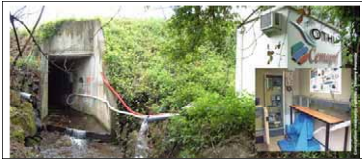
Figure 21 : Vue (éclatée) de l'unité de mesure n°1 qui pilote le déclenchement des unités amont et aval. Les flux sont dérivés vers un canal équipé de capteurs en continu et d'un préleveur pour analyses chimiques plus détaillées au laboratoire. (photo T. Fournier)
