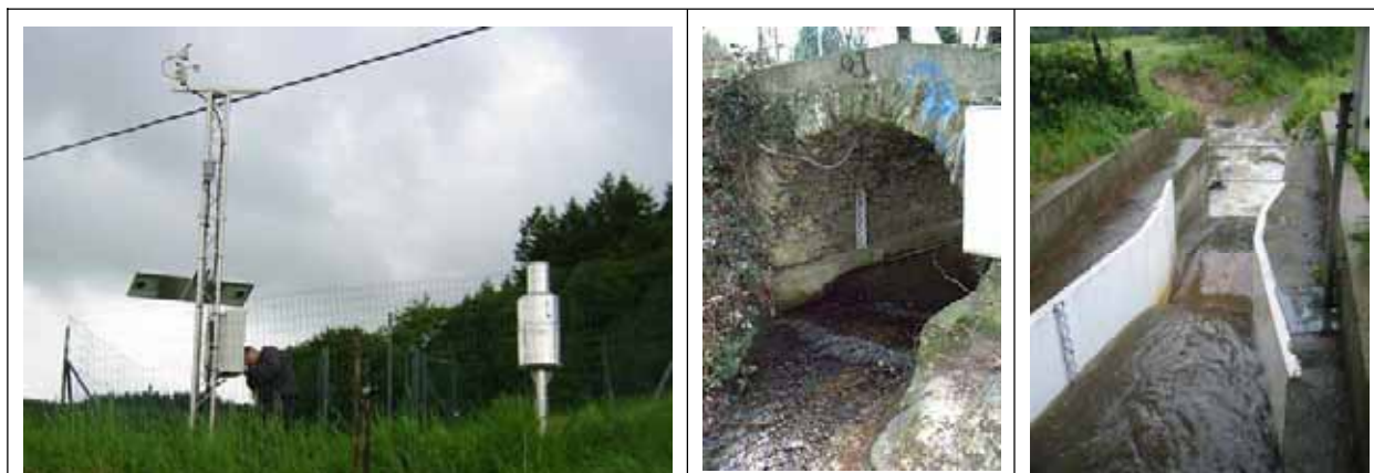
Figure 19 : La station météo de Montromant (comm. Yzeron), le canal Parshall de la station de la Léchère et la section de contrôle du vieux pont de la barge sur la Chaudanne (Grézieu)
