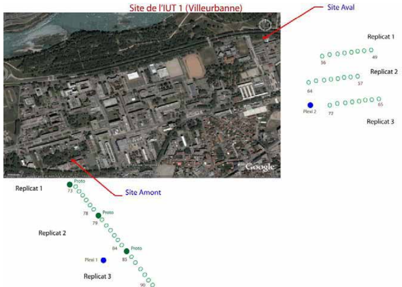
Figure 14: Vue aérienne du bassin d'infiltration de l'IUT (Villeurbanne) montrant la localisation et la disposition des différents piézomètres métalliques et Plexiglas installés en 2006.
