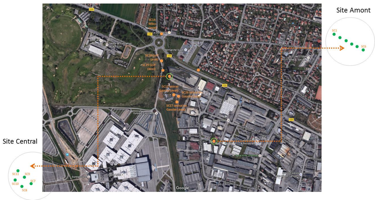
Figure 9. Vue aérienne du bassin d'infiltration de Django Reinhardt (Chassieu) montrant la localisation des différents piézomètres
