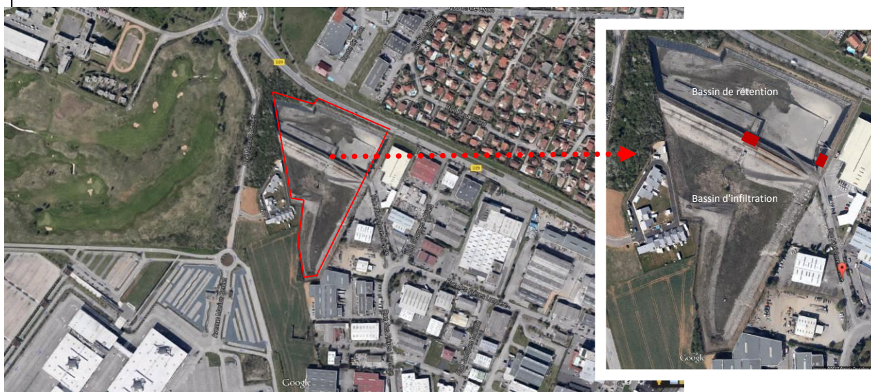
Figure 3. Photo aérienne du bassin versant de Chassieu et zoom sur le dispositif de retenue / infiltration situé à l'exutoire
