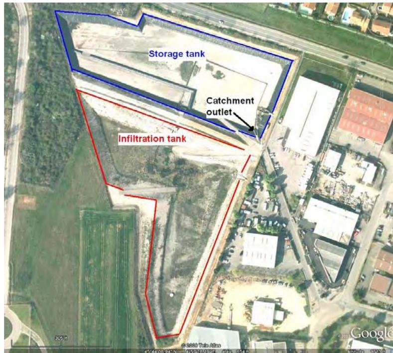
**Figure 3-3.** Vue aérienne des bassins de rétention et d'infiltration à l'exutoire de Chassieu (source Google Earth<sup>®</sup>).
