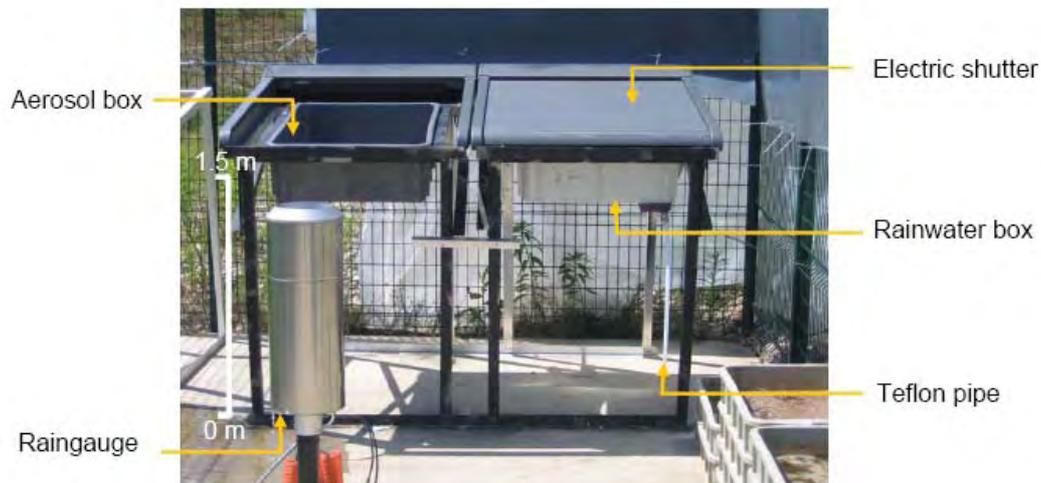
**Figure 4-1.** Prototype échantillonneur des retombées atmosphériques sèches (compartiment ouvert à gauche) et des eaux météoriques (compartiment fermé à droite) installé à Chassieu (photo AD).
