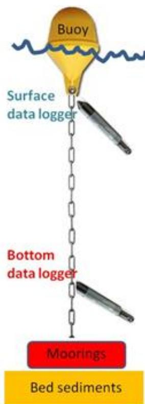
Figure 2 : Système de fixation des deux sondes HOBO placées (50 cm sous la surface) (surface data logger) et en profondeur (20 cm au-dessus du fond) (bottom data logger).
