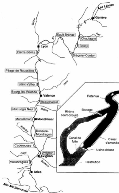
Figure 4 Situation des 15 aménagements en dérivation du Rhône gérés par la CNR, et configuration type des aménagements.
