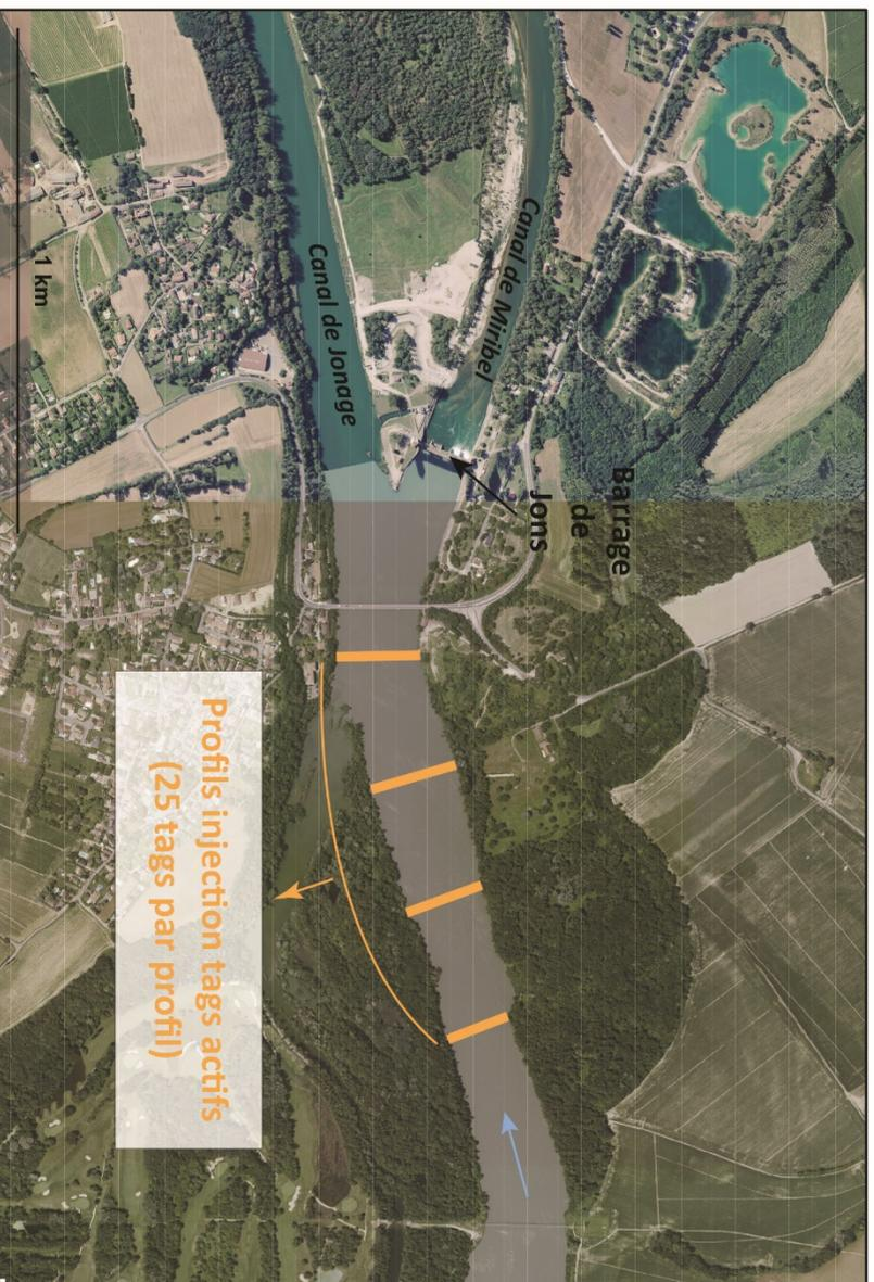
Figure 7 - Localisation des profils d'injection des tags actifs à l'amont du barrage de Jons
