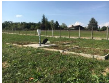
Lysimètres in situ - septembre 2020
