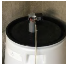
Hauteur d'eau : capteur ultra-son low-cost
