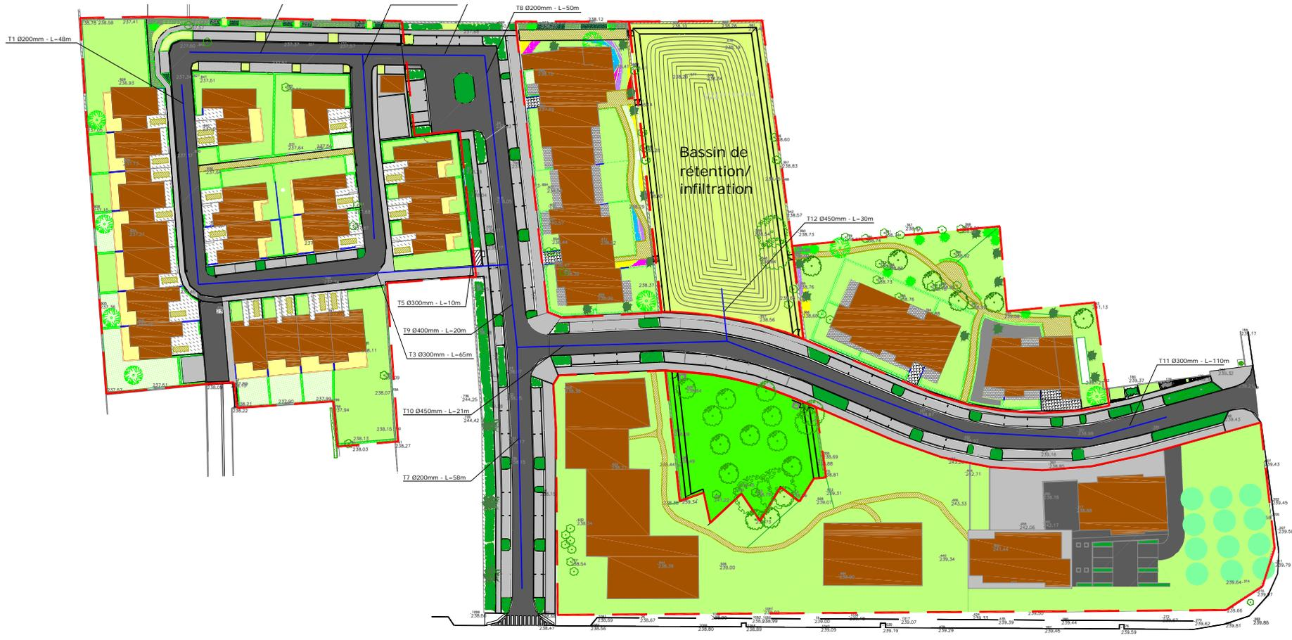
**Figure 1.14 - Alternative 2 - système drainé par bassins**
