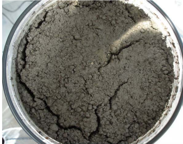
Figure 3 : Formation de fissure à la surface des sédiments entre les phases d'infiltration
