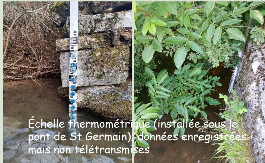
Échelle thermométrique (installée sous le pont de St Germain), données enregistrées mais non télétransmises
