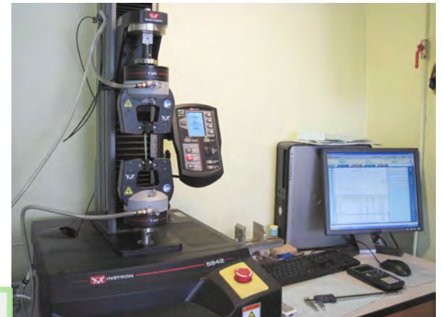
Machine d'essai universelle (mesure de traits biomécaniques)
