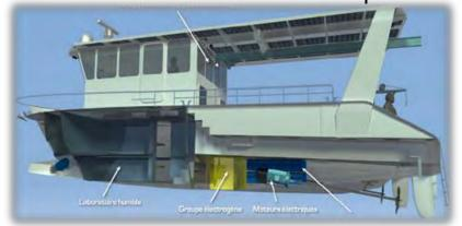
12 à 14 X 4 m Labo sec / humide Electrique / solaire / appoint diesel vitesse WC, Treuil, couchettes, positionnement dynamique...
