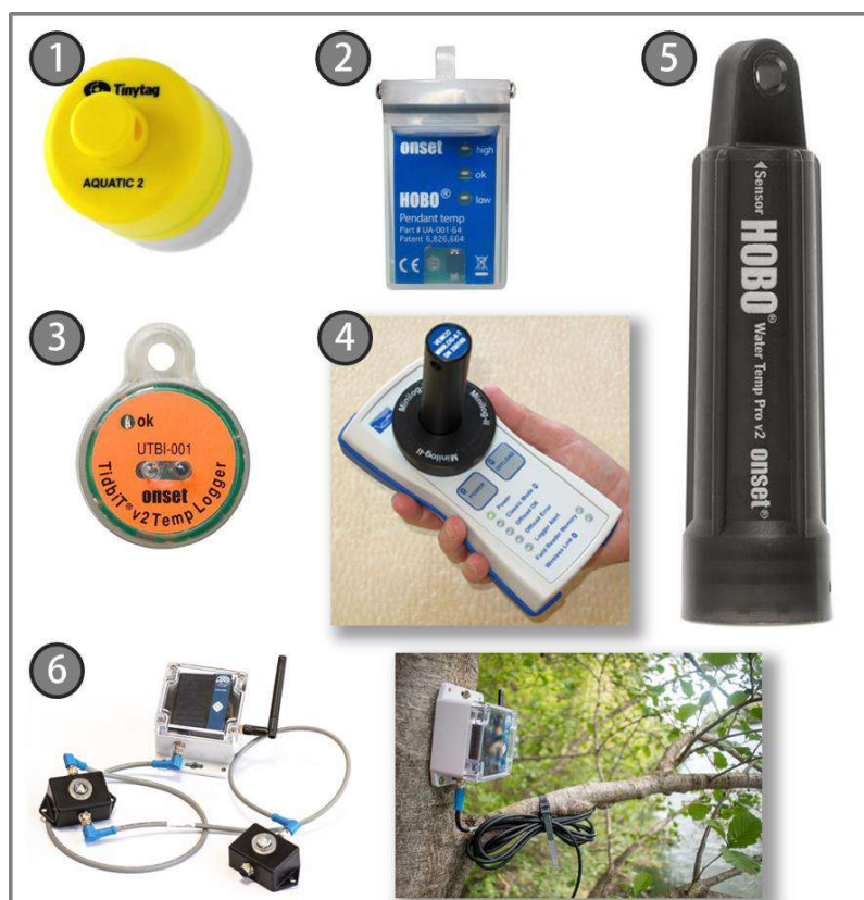
Figure 35. Illustration des enregistreurs de température les plus fréquemment utilisés. Les numéros associés se réfèrent au Tableau 6 et aux sources des photos ci-dessous :
