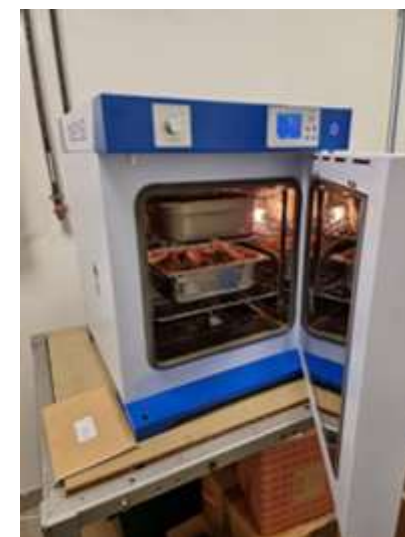
Séchage des sédiments
