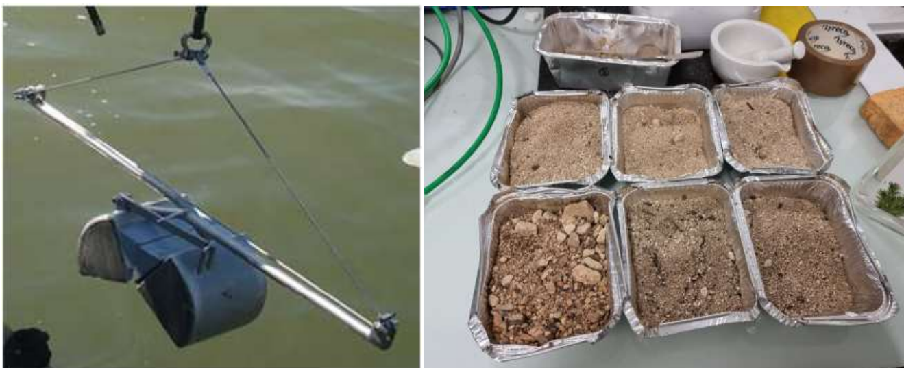
Prélèvements in situ par pelle Van Veen
