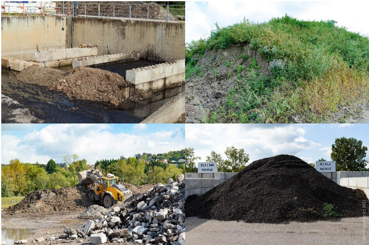
Figure 7 : Plateforme Neoter® à Ternay (69). En haut à gauche, le ressuyage d'un sédiment à la siccité faible, en haut à droite le sédiment issu du bassin de rétention de Minerve (69), en bas à gauche le retournement mécanique d'une biopile, et en bas à droite un stock de granulat 0–31.5 recyclé prêt à être valorisé
