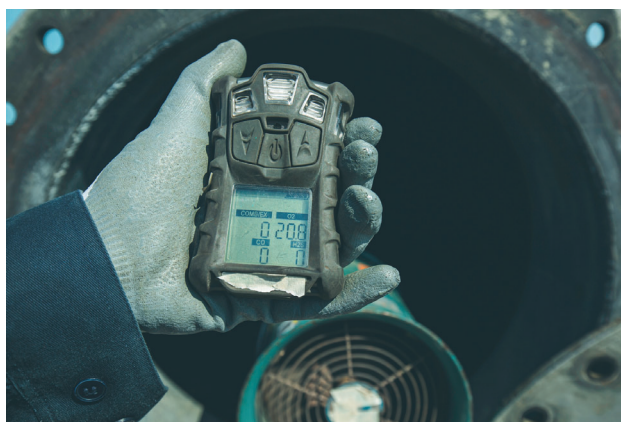
Mesure H 2 S en réseau d'assainissement
