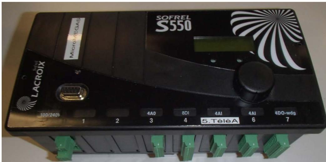
Figure 11. Photo de la centrale d'acquisition sélectionnée (Sofrel S550) [1] Alimentation, [2] emplacement de la carte pour PT100, [3] Sorties Analogiques pour pilotage du préleveur, [4] Entrées Digitales pour auget, [5] Entrées Analogiques télé-alimentées pour conductivité, [6] Entrées Analogiques pour débitmètre électromagnétique, [7] Sorties Digitales "watchdog" pour communication de secours avec le préleveur
