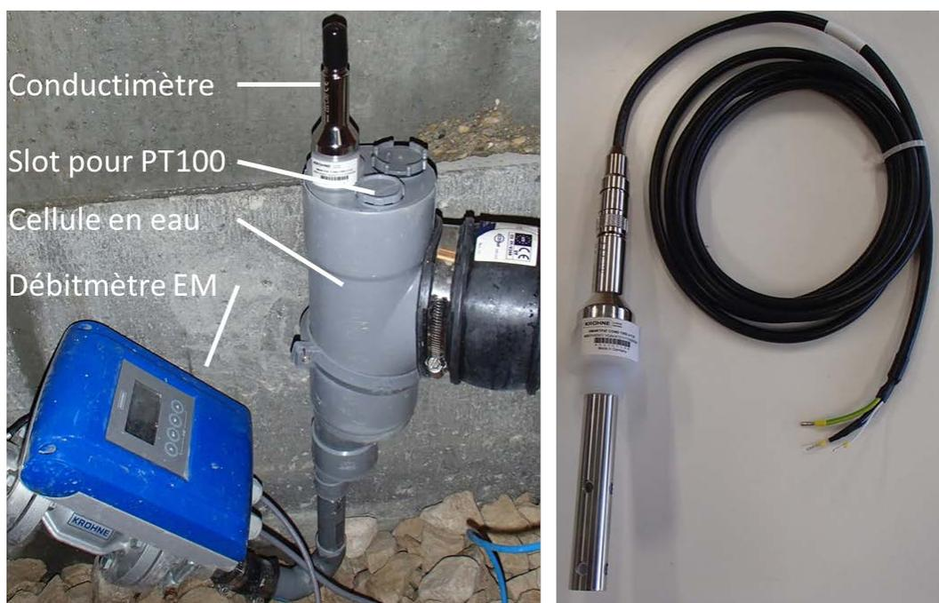
Figure 13. Photo de l'emplacement de la sonde et de la sonde elle-même de conductivité (Smartpat de la marque Krohne)
