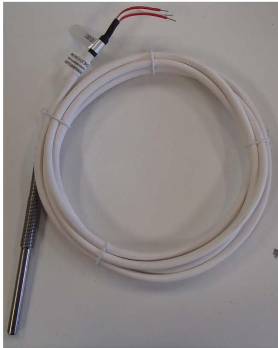
Figure 14. Sonde de température choisie
