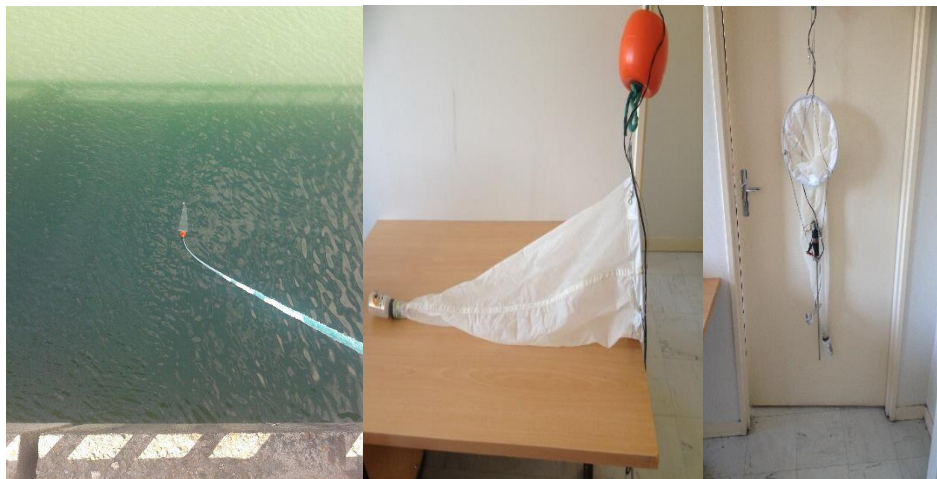
Figure 2 : Dispositif utilisé pour les échantillonnages à partir de ponts
