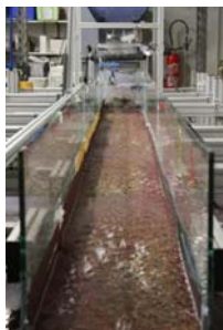
Figure 3.34. Lit pavé avec bancs immergés
