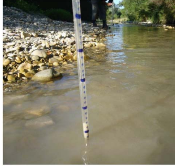
Figure 2.10. A - Prélèvement de la faune hyporhéique par la méthode de pompage Bou-Rouch ; B - Mesure de la différence de charge entre les eaux de surface et les eaux hyporhéiques (ici, une zone d'exfiltration potentielle).
