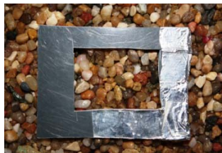
Figure 3.12. Gabarit utilisé pour l'indice granulométrique, ici un exemple de classe « MAX ».
